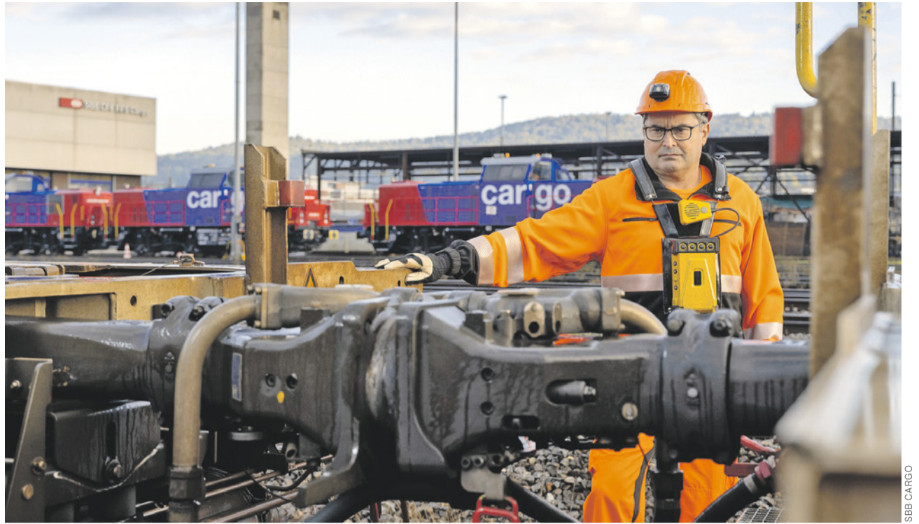
Der Bundesrat will den Einzelwagenladungsverkehr modernisieren, vor allem mit der digitalen automatischen Kupplung. So soll der EWLV gegenüber der Strasse konkurrenzfähiger werden und diese auch entlasten.
